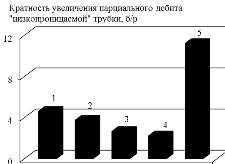
Рисунок 5 – Диаграмма изменения кратности увеличения парциального дебита "низкопроницаемой" трубки, где соотношение ДР9-8177: ZnO : АХ (масс. %) соответствуют; 1 - 0,8 : 0 : 0,07; 2 - 0,7 : 0,04 : 0,04; 3 - 0,7 : 0,06 : 0,05; 4 - 0,7 : 0,06 : 0,05; 5 - 0,8 : 0,07 : 0,06
